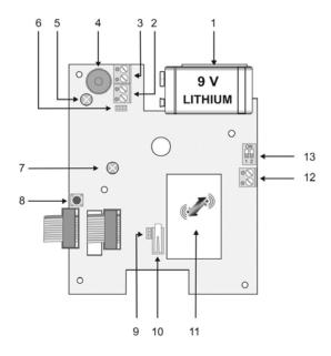
Bitte **entweder** eine 9 V Batterie anschließen **oder** die 12 V externe Stromversorgung benutzen.
